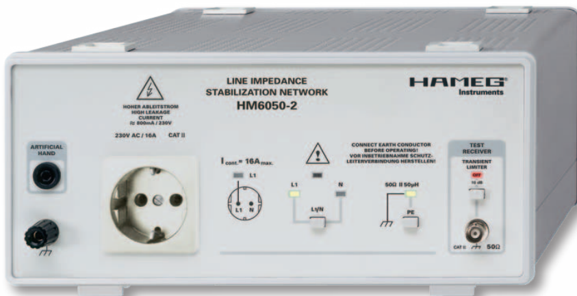
Fot. 1. Sieć sztuczna (LISN), taka jak HAMMEG HM6050-2 jest używana do odizolowania, identyfikacji i pomiaru zaburzeń przewodzonych
