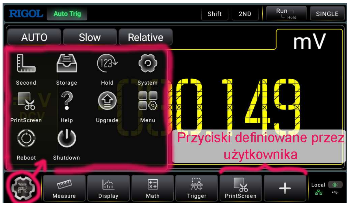
Rys. 3. Konfigurowalny ekran multimetru DM858 z panelem dotykowym
