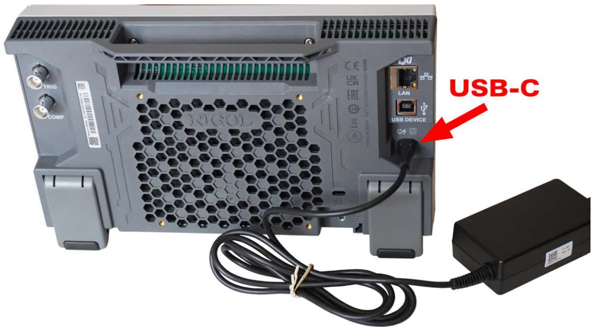
Fot. 1. Zasilanie multimetru DM858 z użyciem zasilacza zewnętrznego i kabla USB-C
