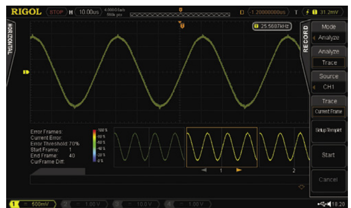
Rysunek 4. Ustalenie ramki wzorcowej do dalszej analizy
