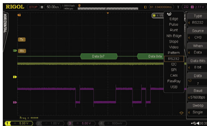
Rysunek 10. Zaawansowane tryby wyzwalania oscyloskopu DS4054
