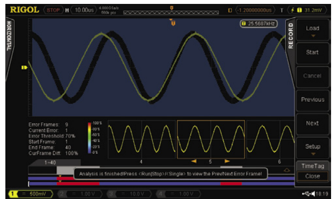
Rysunek 6. Badanie różnic pomiędzy zapisanymi ramkami metodą testu Pass/Fail
