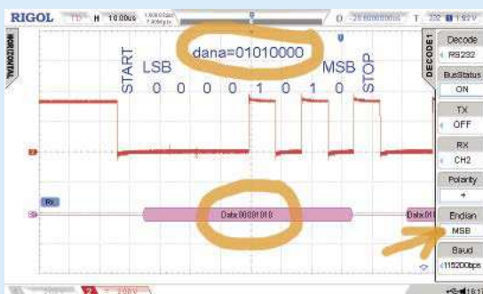
Rysunek 15. Błędy interpretacji danych wynikające z nieprawidłowo ustawionego parametru „Endian”
