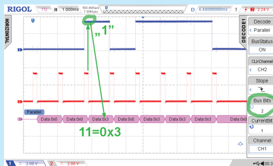
Rysunek 50. Interpretacja danych w przypadku zadeklarowania nieprawidłowej liczby danych interfejsu równoległego
