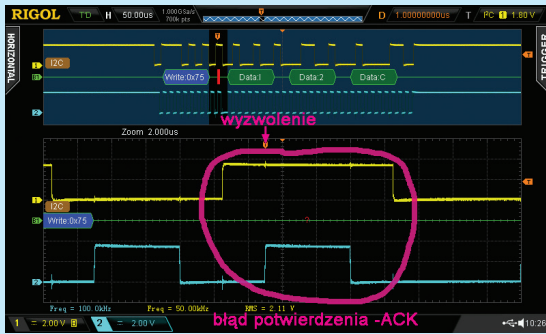
Rysunek 39. Wyzwolenie na błędzie potwierdzenia MissingAck
