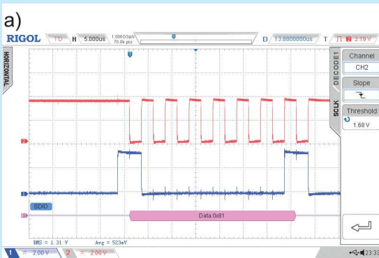
Rysunek 28. Błąd interpretacji danych przy nieprawidłowym ustawieniu parametru „Endian”
