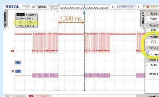
Rysunek 19. Wyzwalanie szerokością impulsu przy pracy z analizatorem protokołów
