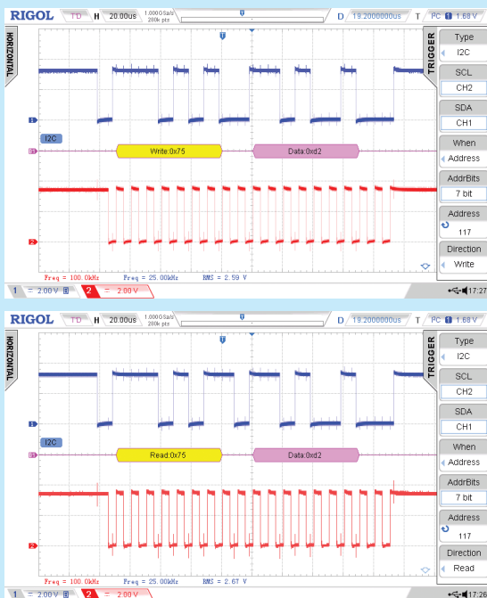
Rysunek 40. Wyzwolenie na adresie 75h w trybie: a) zapisu, b) odczytu
