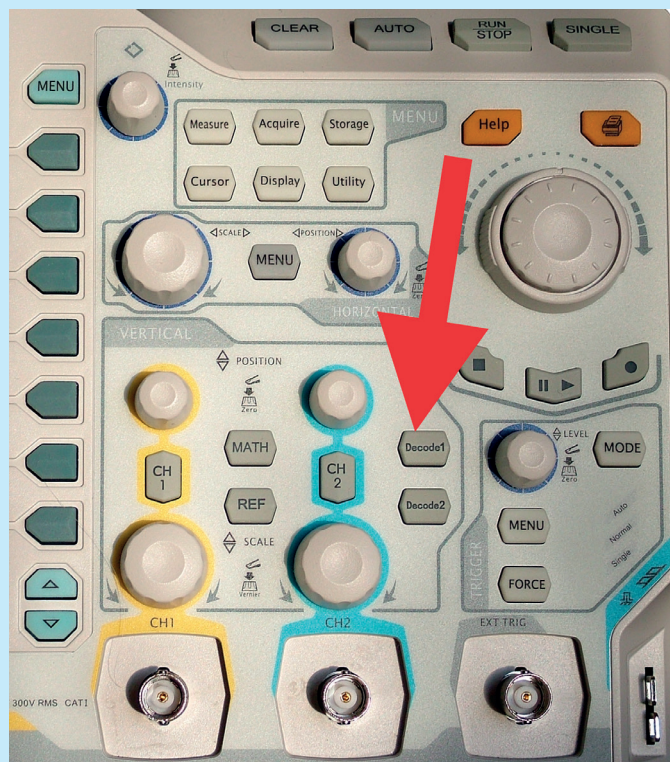
Fotografia 3. Lokalizacja przycisku Decode1 na płycie czołowej oscyloskopu DS2202
