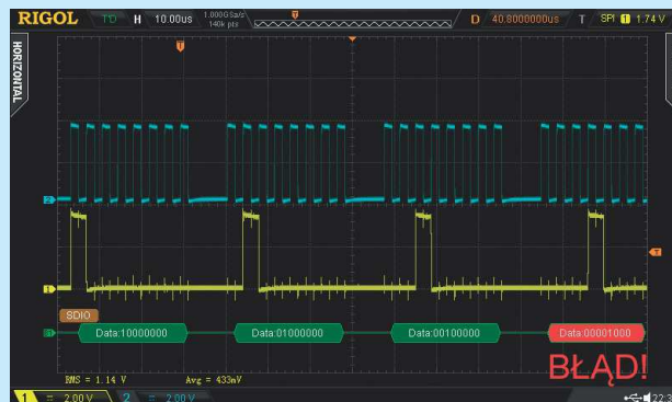
Rysunek 26. Błąd odczytu danej niemieszczącej się na ekranie
